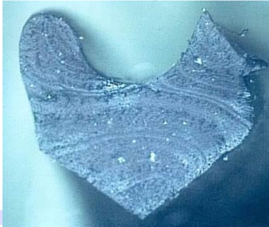
Abb. 6: Ursprüngliches Profil des Radialwellendichtrings aus Abb. 5
