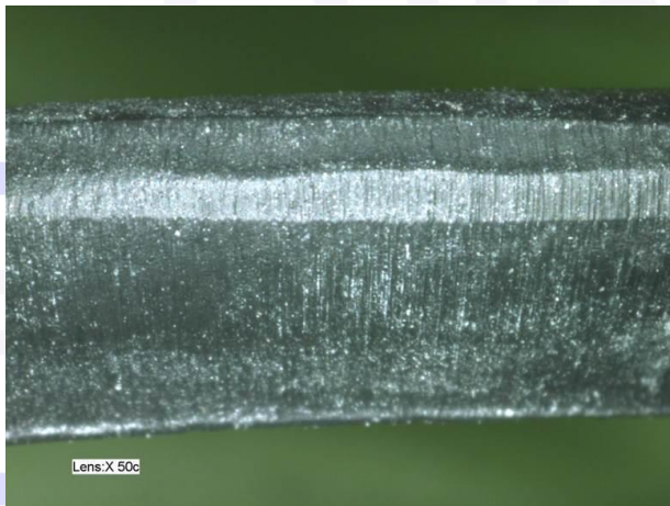
Abb. 10: Draufsicht Außendurchmesser des geschädigten O-Rings aus Abb. 7
