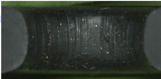
Abb. 4: Innenseite eines aufgeschnittenen EPDM O-Rings aus einem Thermostatventil: In den Riefen sind deutlich Metallpartikel zu erkennen (Hydroabrasion)
