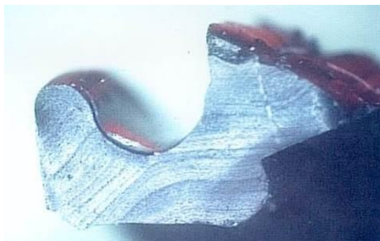
Abb. 5: Starker Abrieb an der Dichtlippe eines Radialwellendichtrings nach Trockenlauf bzw. Mangelschmierung und unzulässig hoher Druckbeaufschlagung
