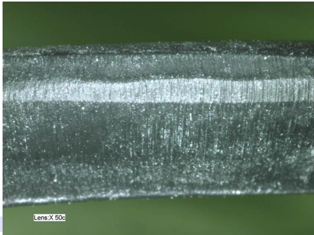
Abb. 6: Draufsicht Außendurchmesser des geschädigten O-Rings aus Abb. 5 mit deutlichen Riefen aus dem Abriebvorgang
