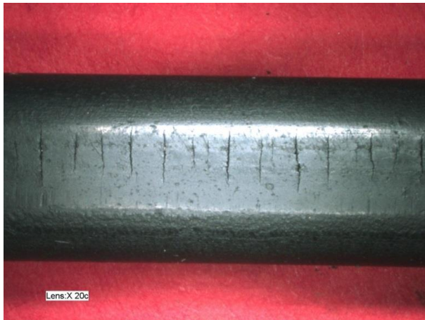
Abb. 4: Typisch für eine unzulässige thermische Beanspruchung ist neben der bleibenden Verformung eine komplette Versprödung, die sich hier in der Rissbildung nach leichter Biegebeanspruchung im Kontaktbereich der Dichtung zeigt
