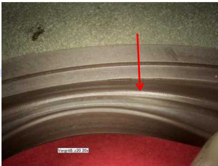
Abb. 15: Entformungsrisse an einer Formdichtung
