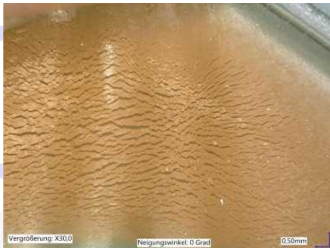
Abb. 26: Chem. Angriff einer FVMQ-Membrane: Die Risse erstrecken sich über eine größere Fläche
