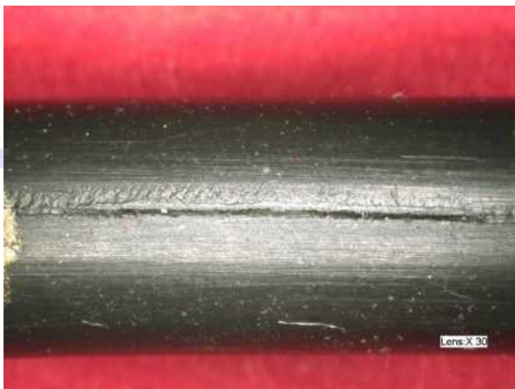
Abb. 12: Schrumpfriss an einem O-Ring
