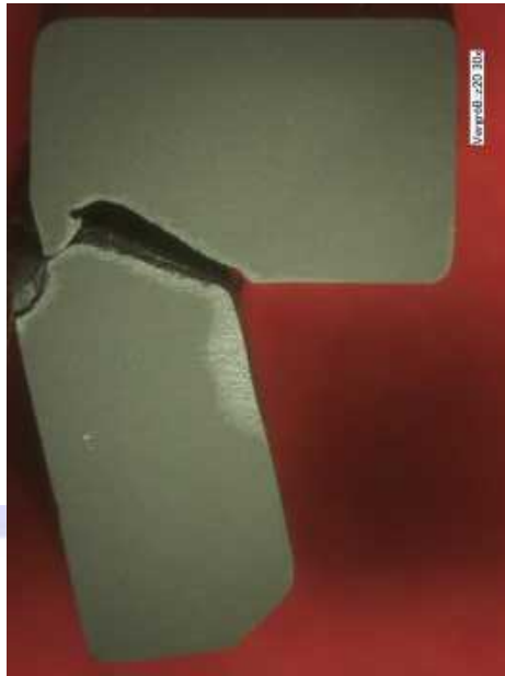
Abb. 16: Entformungsriß an einem Dichtelement
