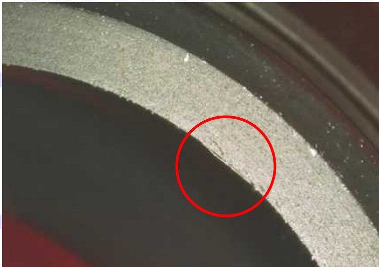
Abb. 17: Einriß entstanden durch den Nachbearbeitungsschritt „Abstechen der Dichtkante“
