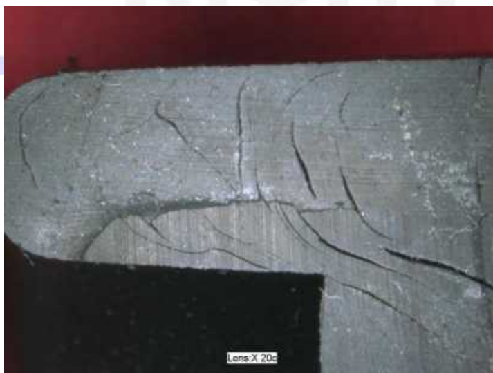
Abb. 8: Herstellungsbedingte Risse aufgrund einer überlagerten Mischung
