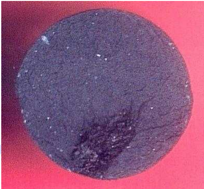
Abb. 11: Riss, ausgelöst durch Fremdmaterialeintrag
