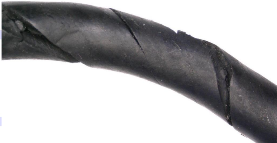
Abb. 3: O-Ring Spirallisse im fortgeschrittenen Stadium
