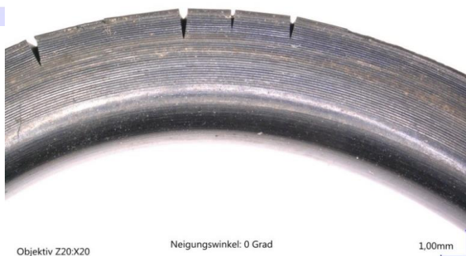
Abb. 8: Versprödeter NBR O-Ring zeigt beim Biegen Risse (umlaufenden Riefen sind ein Abdruck der Gegenfläche) Abgrenzung zu Ozonrissen: Verhärtung rissiger Zonen. Bei Ozon- oder Ermüdungsrisse sind Risse in der noch elastischen Elastomermatrix.
