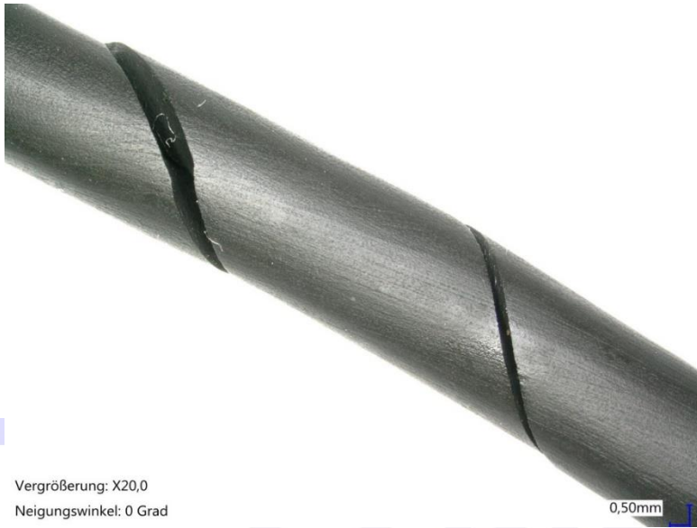
Abb. 2: Spiralliss an einem O-Ring im fortgeschrittenen Stadium, bei weiterer Belastung käme es bald zu einem vollständigen Durchriss der Dichtung
