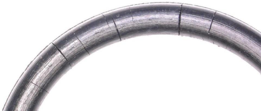
Abb. 7: Typische Ozonrisse an einem O-Ring (radialer Verlauf in einem Winkel von 90^\circ zur Umfangstangente)
