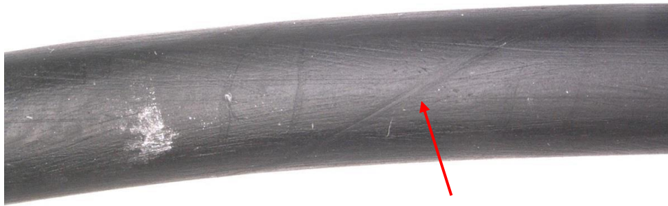
Abb. 5: O-Ring mit leichten spiralförmigen Markierungen, siehe Pfeilmarkierung (= Anfangsstadium eines Spiralarisses)
