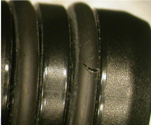
Abb. 7: Riss aufgrund eines Vulkanisationsfehlers, erkennbar am parabelförmigen Rissverlauf symmetrisch zur Formtrenneben
