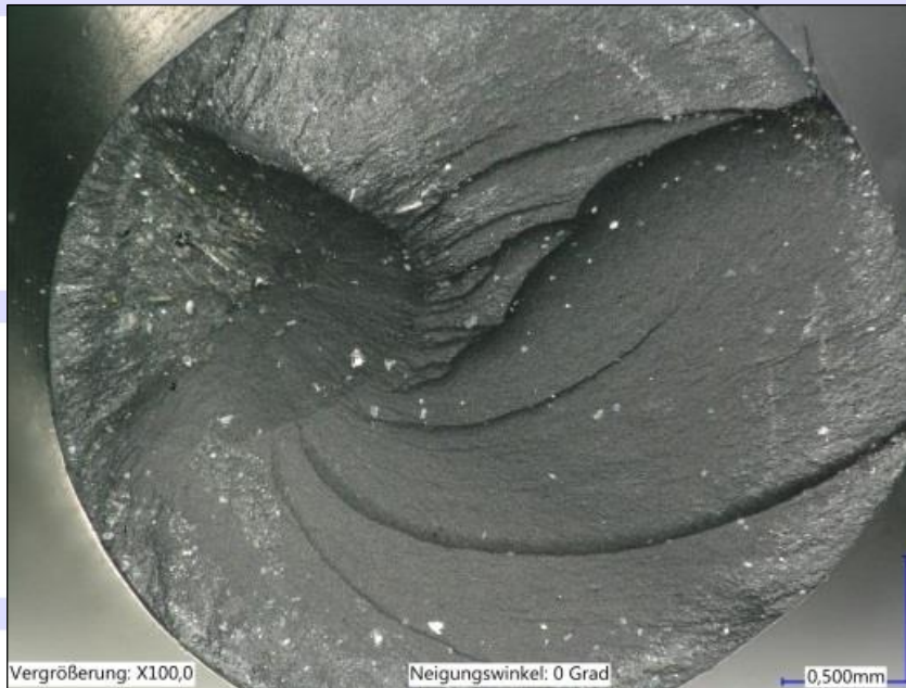
Abb. 5: O-Ring mit leichten spiralförmigen Markierungen, siehe Pfeilmarkierung (= Anfangsstadium eines Spiralarisses)
