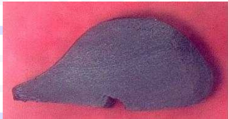
Abb. 16: FKM O-Ring nach wenigen Wochen Einsatz in einem Press-fitting bei 175°C Wassertemperatur
