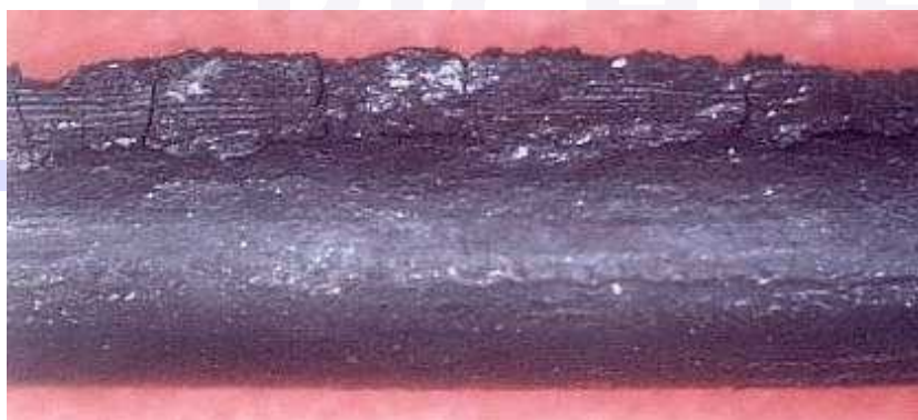
Abb. 13: FKM O-Ring nach wenigen Monaten Einsatz bei 130°C, wasserseitig zerstört
