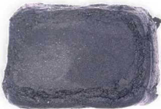
Abb. 20: EPDM Probe nach Wasserinlagerung bei 70h/150°C. Die hohe Dichte von 1,46 g/cm 3 weist darauf hin, dass helle Füllstoffe verwendet wurden und Ruß lediglich als Farbpigment beigelegt wurde.
