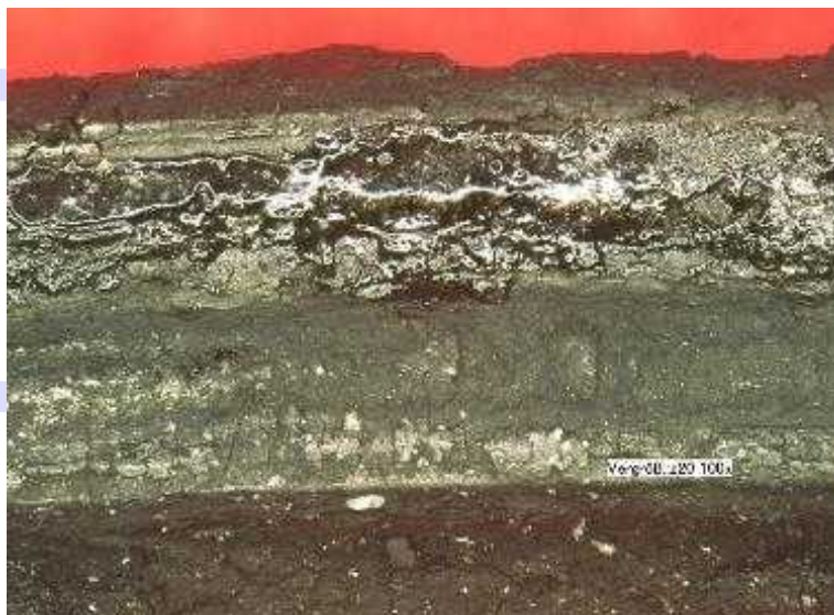
Abb. 17: Durch Autoxidation geschädigte EPDM-Dichtung
