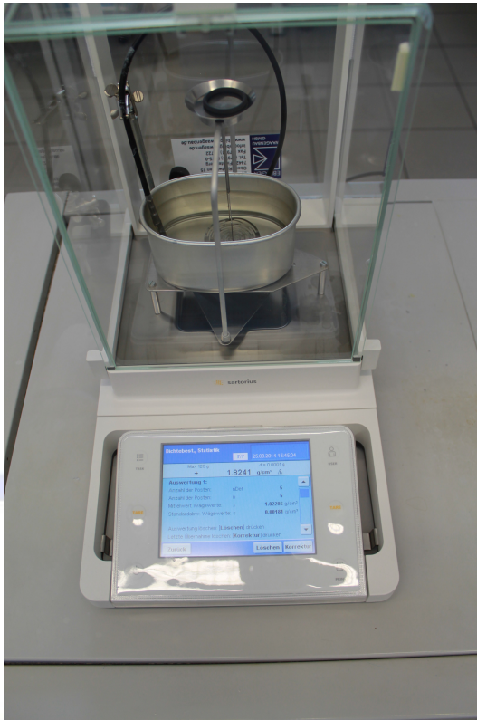
Bild 1: Dichtewaage: Zuerst wird die Masse des O-Rings in Luft bestimmt, danach in dem mit Ethanol gefüllten ovalen Gefäß darunter.
