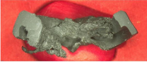
**Bild 6:** Stark gequollene EPDM-Dichtung nach einer dynamischen Beanspruchung einer Lippendichtung.
