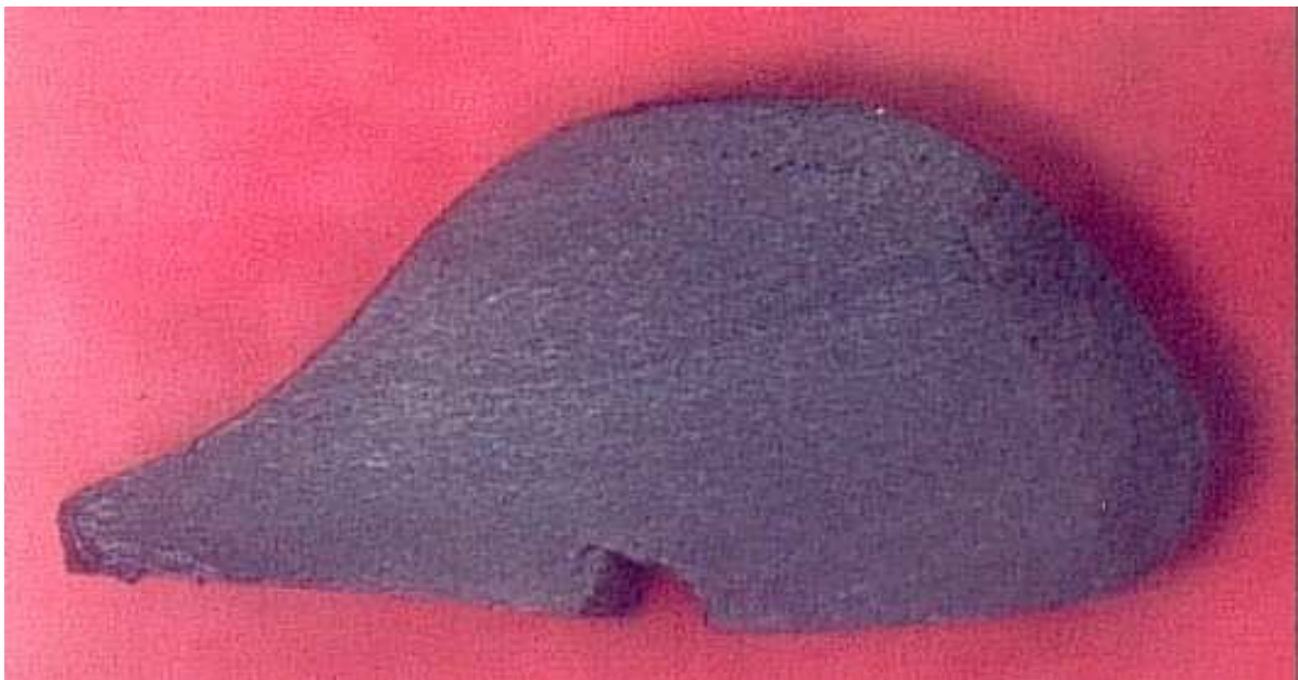
Bild 4: FKM O-Ring nach wenigen Wochen Einsatz bei 175°C in einem Pressfitting bei 175°C Wassertemperatur.
