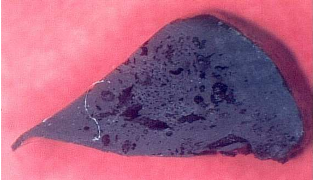
Bild 3: FKM O-Ring (Aflas) nach Einsatz von ca. 5 Jahren in einer Armatur eines Fernwärmenetzes bei Heißwassertemperaturen bis zu 170°C (Dreiecksnut)
