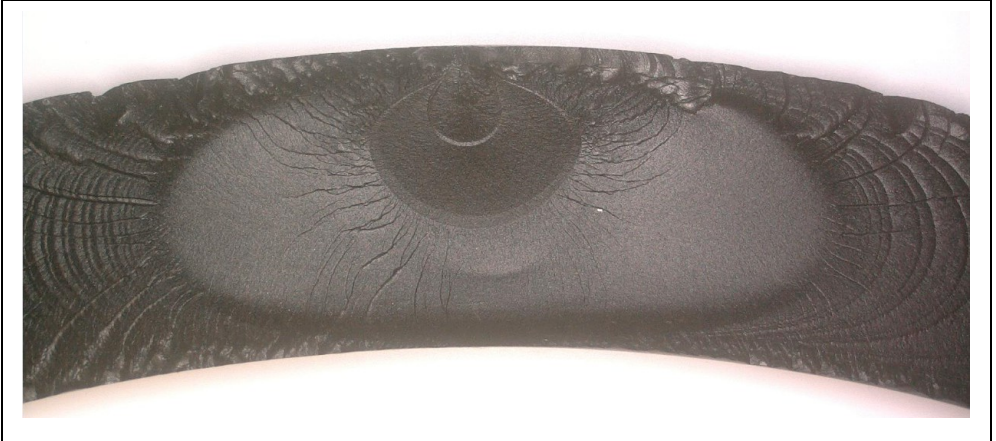
Bild 2: Beispiel 1-Risse am Aussendurchmesser
