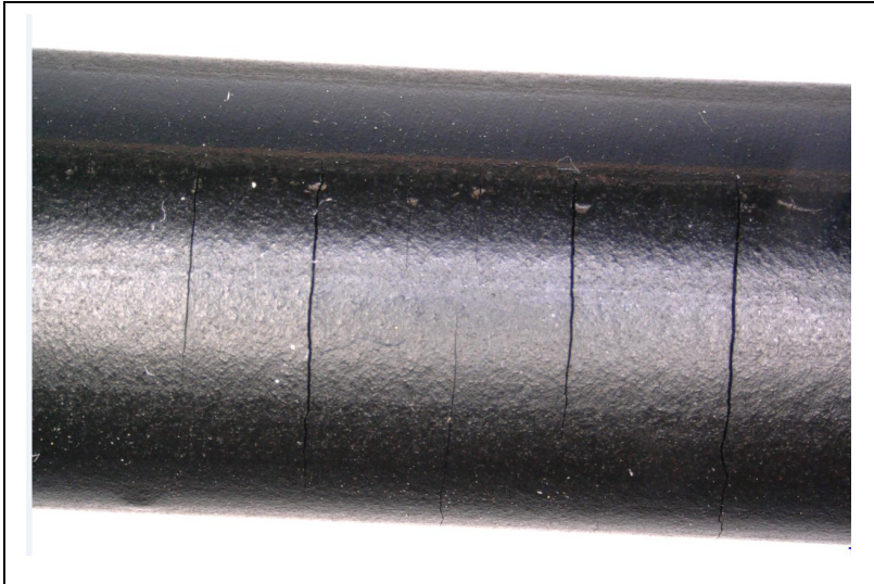
Bild 6: Risse beim Biegen am O-Ring mit der angeblich geringeren thermischen Beanspruchung
