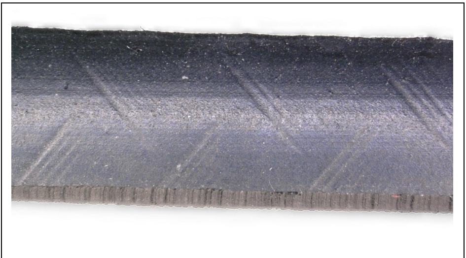
Bild 9: Beispiel 3- aktuelles Serienmuster nach Ozonprüfung
