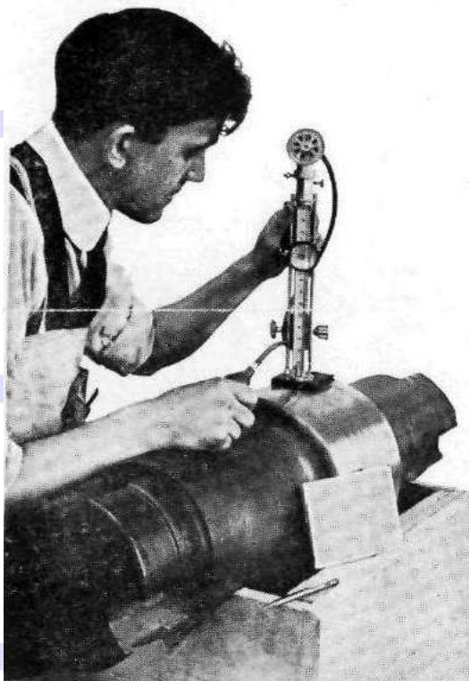
Abb. 1: Darstellung eines Shore-Scleroscopes mit einer vertikalen Skala aus einem frühen Firmenprospekt von „The Shore Instrument & Mfg. Co. Inc.“ 5 Ein Arbeiter bestimmt die Härte einer metallenen Welle.
