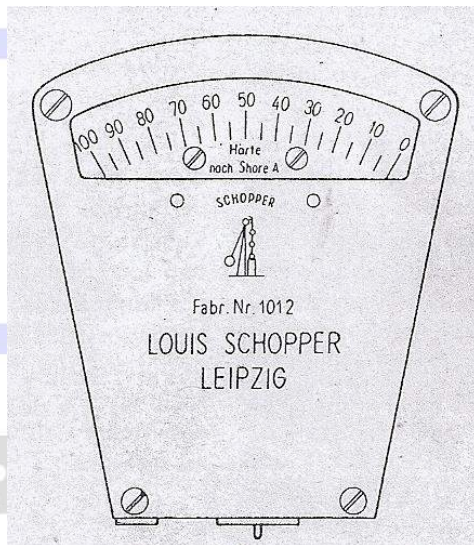
Abb. 12: Schemazeichnung eines Shore A Härteprüfgerätes von Louis Schopper, Leipzig, um 1940 46
