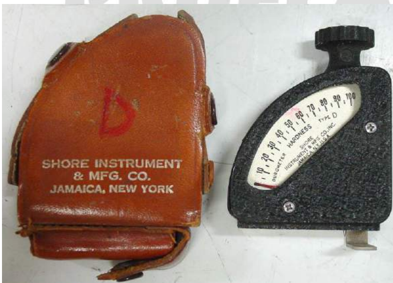
Abb. 11: Ein späteres Beispiel eines Shore D Handprüfgerätes („quadrant type“) mit dazugehöriger Ledertasche, (Abdruckerlaubnis mit freundlicher Genehmigung von „Toronto Surplus & Scientific“, Kanada)
