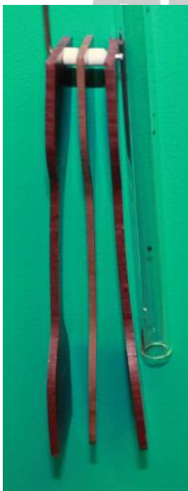
Abb. 6: Die weißen Keramikringe dienen als Distanzhalter, um eine Migration von Inhaltsstoffen zu vermeiden.
