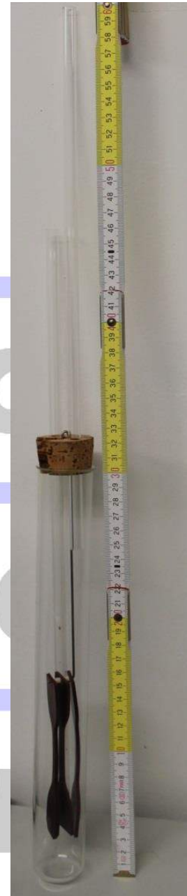
Abb.4: Mit drei ASTM Probekörpern (Die C) bestückte Zelle (= Borsilikatglasröhre) nach ASTM D865
