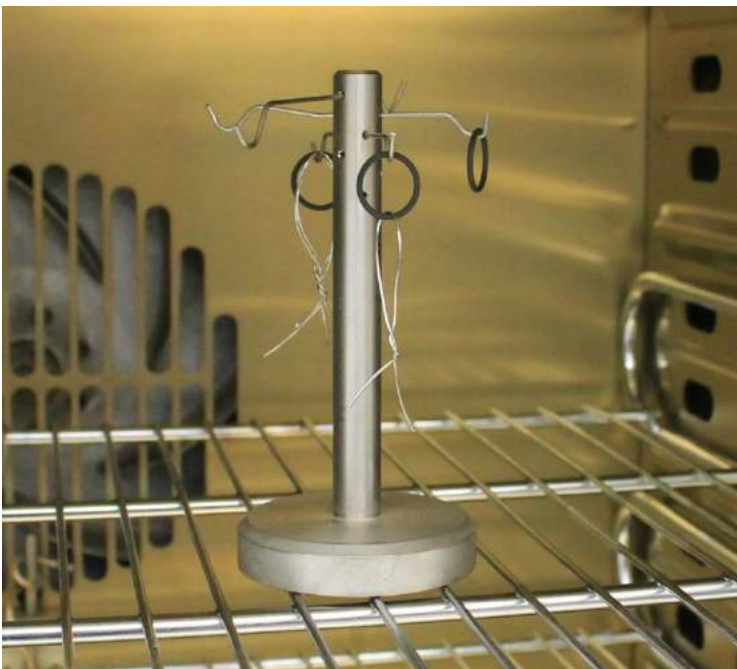
Abb.3: Heißluftalterung an O-Ringen:
