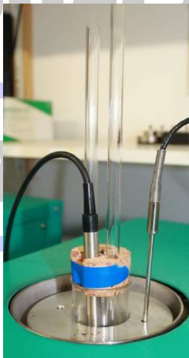
Abb. 7: In den Ofen eingeführte Zelle mit zusätzlicher Temperaturüberwachung in der Zelle (linkes Kabel) Der rechte Sensor im Aluminiumblock regelt die Temperatur.
