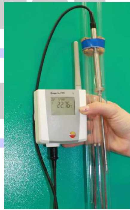
Abb.8: Zusätzlicher Temperatursensor zur Überwachung der Innentemperatur in der Zelle
