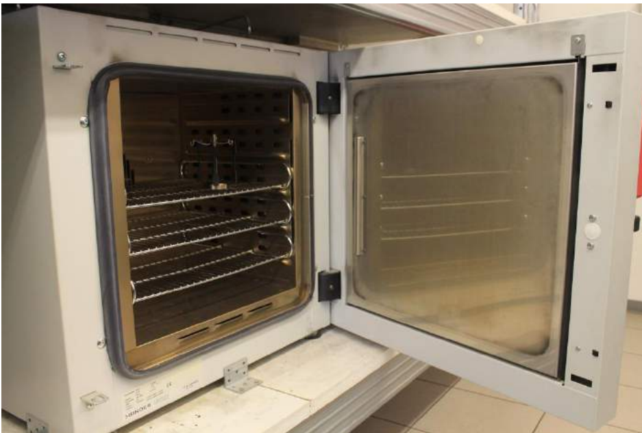
Abb.1: Wärmeschrank mit geöffneter Tür und Einlegegittern, auf welchen die Probekörperalterungen platziert werden
