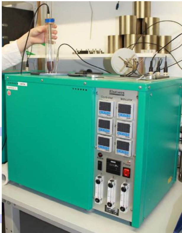
Abb. 5: Einführen der Zelle (=Borsilikatglasröhre) in den Zellenofen
