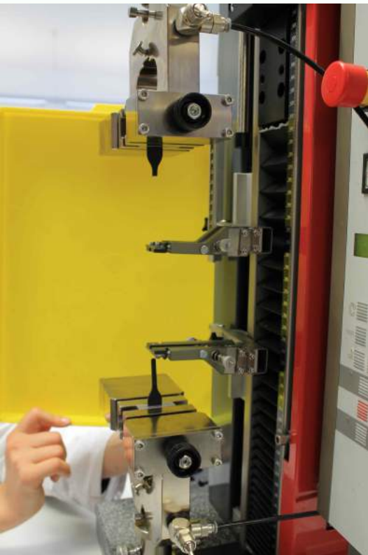
Abb.7: Der gerissene Schulterstab wird aus den Spannbacken entnommen. Dies ist das Ende des Zugversuches.
