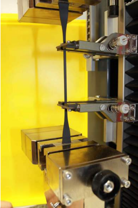
Abb.6: Gedehnter Schulterstab, kurz vor dem Reißen. Die Längenänderungsaufnehmer liegen nun am Schulterstab an und messen dessen Dehnung im genormten Messbereich. Hier wird ersichtlich, wie sich der Querschnitt des Messbereichs durch die Dehnung verjüngt.
