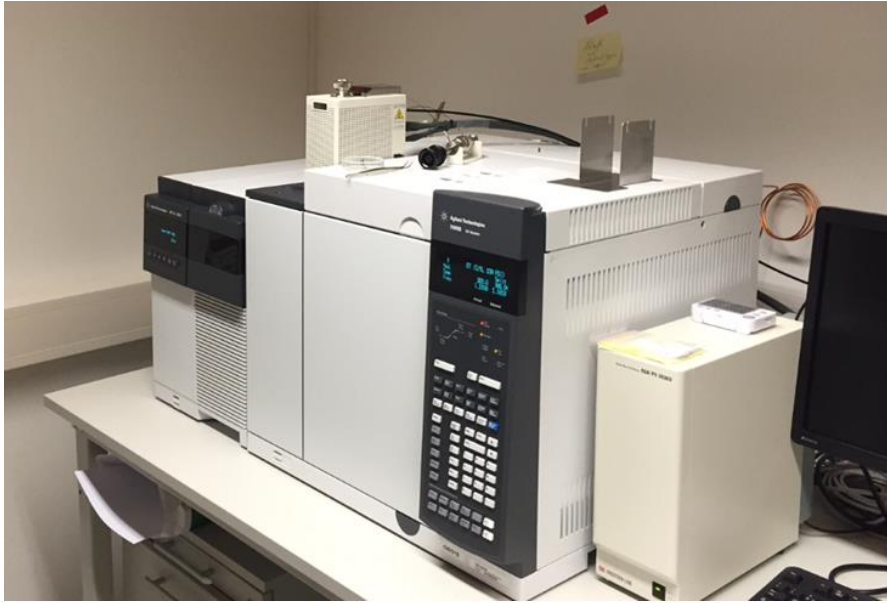
Abb. 3: Besonders für das Reverse Engineering ist die Pyrolyse GC-MS ein wichtiges Instrument (Bild: O-Ring Prüflabor Richter GmbH)
