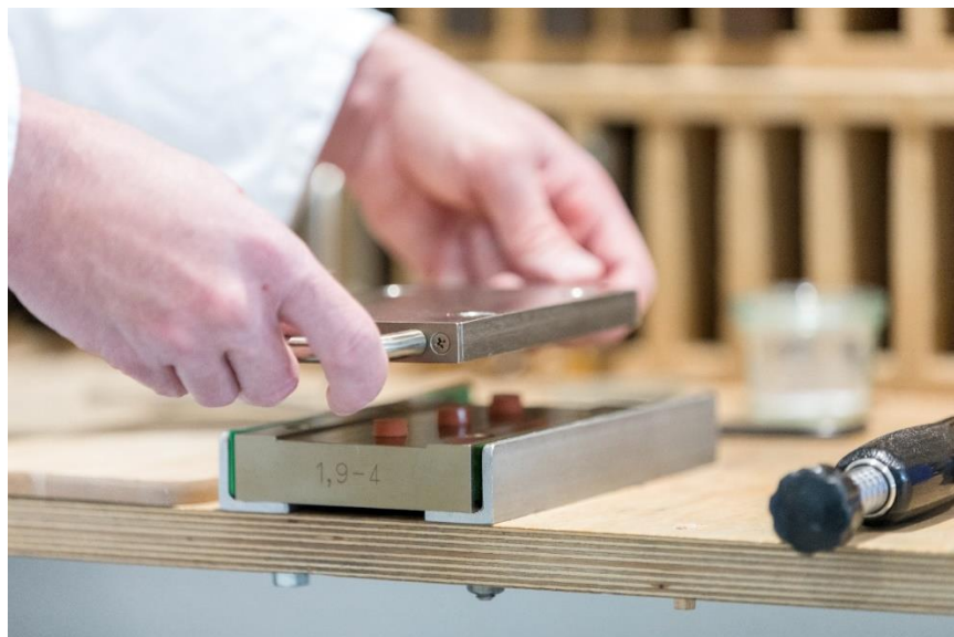
Abb. 1: Die drei braunen Probekörper werden mit Hilfe von Platten für eine Druckverformungsrestprüfung verpresst: Diese Prüfmethode ist eine Sonderform von Alterungsprüfungen. (Bild: Tobias Ehmer)
