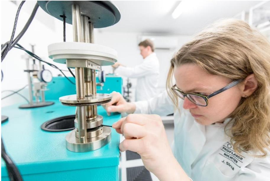
Abb. 2: Prüfung der Druckspannungsrelaxation: Kontinuierliche Messung der abnehmenden Vorspannung während eines Alterungsprozesses (Bild: Tobias Ehmer)
