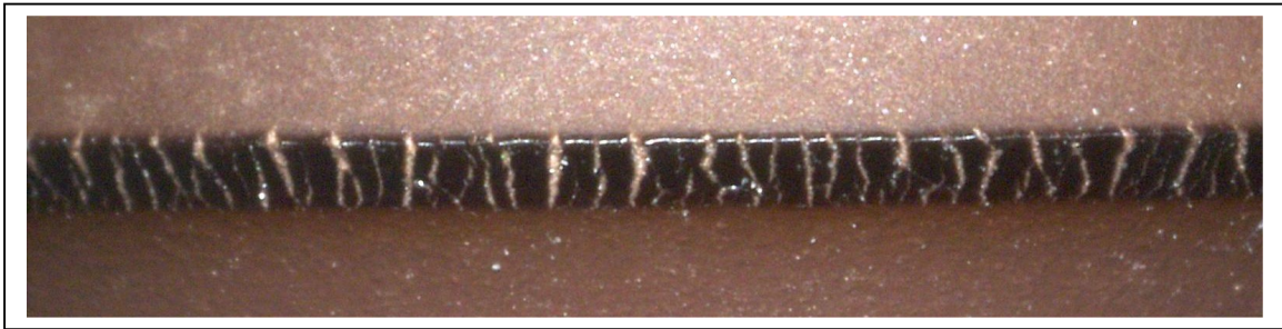
Bild 3: Durch chemischen Angriff zerstörte Dichtkante eines RWDRs
