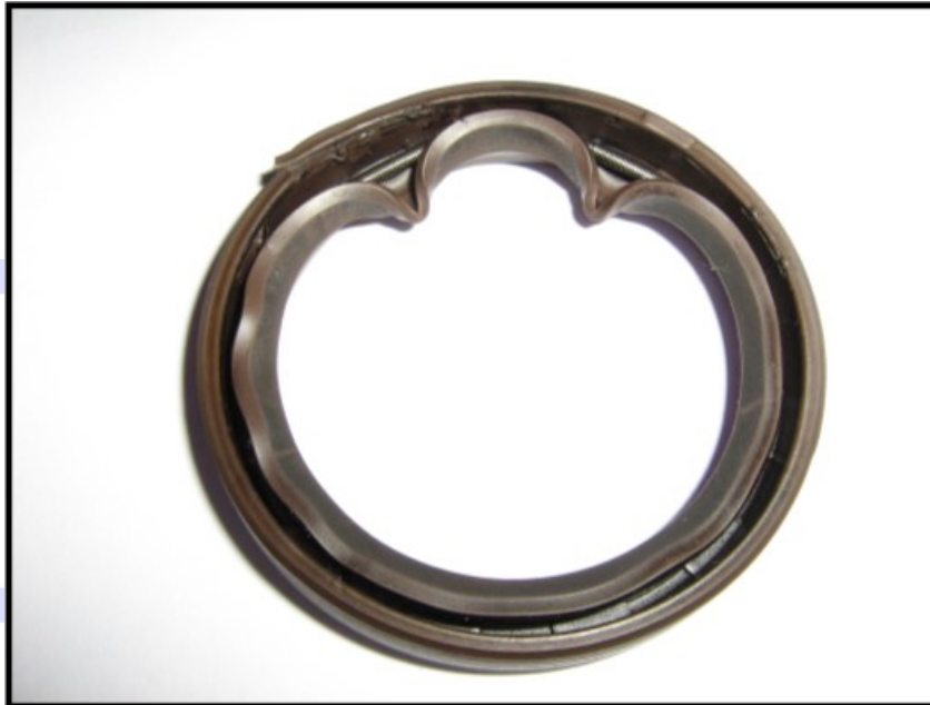
Bild 2-ein durch Quellung ausgefallener RWDR
